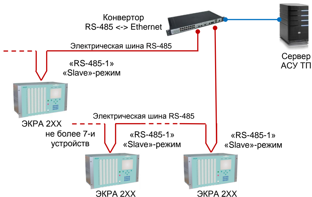
Рисунок 2 – Типовая схема интеграция терминала в АСУ ТП по электрическому интерфейсу RS-485. Комбинированная топология сети
